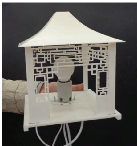
Рис. 87. Светильник из пластика, выполненный на 3D-принтере
